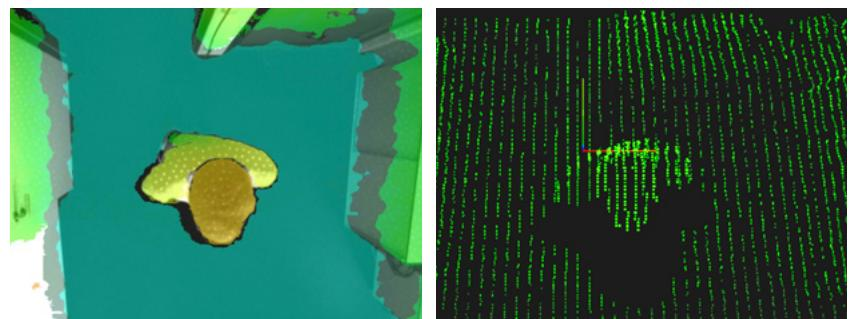
3D-Sensoren erfassen Höheninformationen, die die Grundlage für differenzierte Zählungen sind. Rechts im Bild ist bspw. sehr gut das Kopf / Schulter Verhältnis erkennbar, über das Personen von Objekten unterscheiden werden können.
